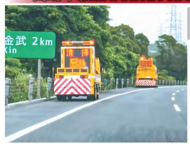
簡易車載型 USIMPACT は、路肩を低速で走行しな がら行う作業の後尾警戒車に搭載し走行車両に警告 を与える為に使用します。
